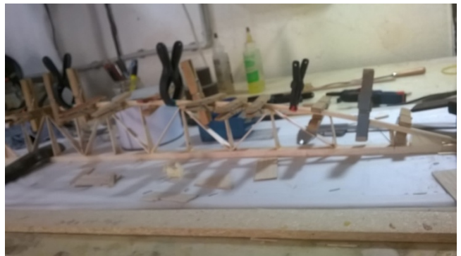
Lo scalo per il montaggio dell'alettone
